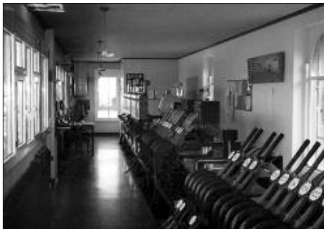
Stellwerk I Romanshorn Hier wurden die Weichen für den Rangierbahnhof und den Ablaufberg gestellt. (Buch: Romanshorn Leben mit der Bahn, Ch. H. Köpfer 2004)
